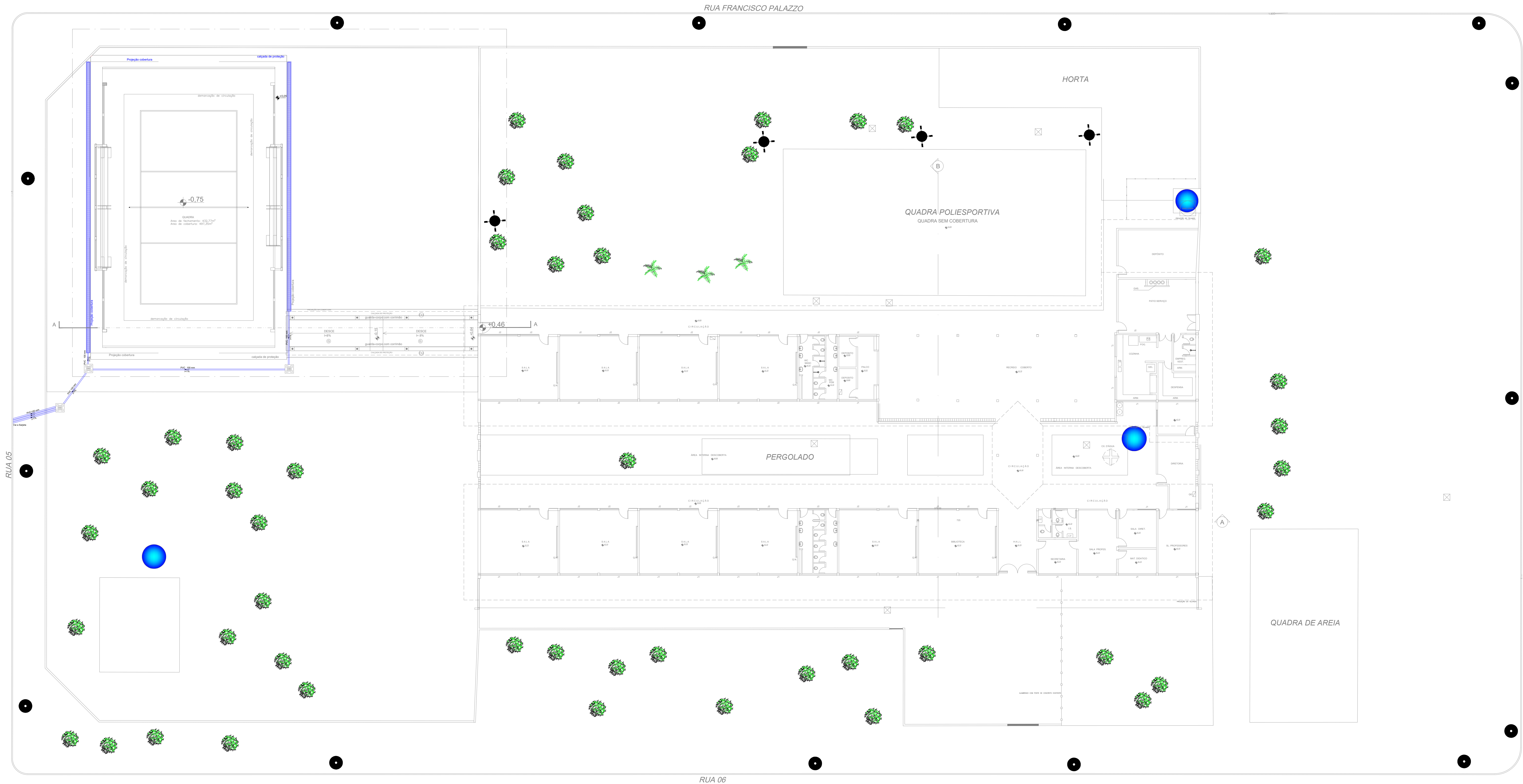
PLANTA BAIXA - CAPTAÇÃO DE ÁGUAS PLUVIAIS ESCALA 1:150
